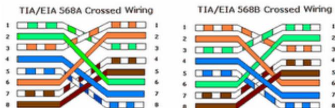
Gambar 2.3 Urutan susunan kabel *cross over*
