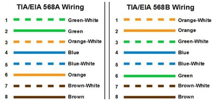
Gambar 2.2 Urutan susunan kabel *straight*
