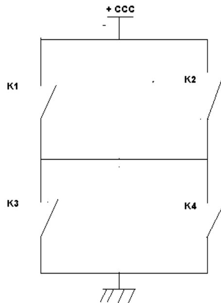
**Gambar 4.1 Driver DC yang digambarkan dengan saklar**
